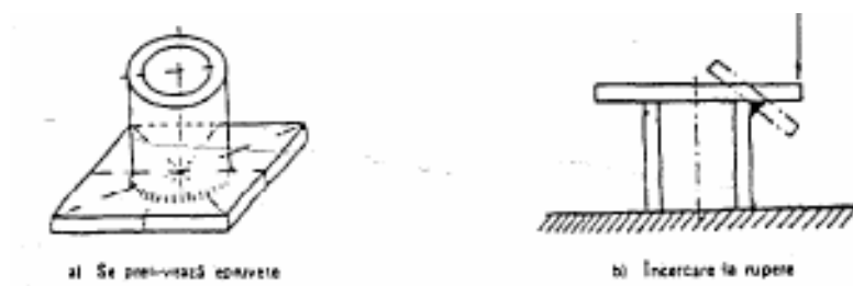
Figura 10- Pregătirea și încercarea la rupere a epruvetelor pentru sudura în colț la țevă. (Dimensiuni în milimetri)
